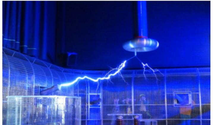
Per costruire una gabbia di Faraday è sufficiente utilizzare un materiale conduttore. Qualsiasi involucro cavo, che sia un foglio continuo o un insieme di sbarre, può essere utile per schermare il campo elettrico.
